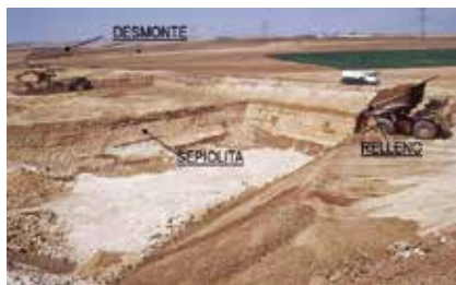
Figura 43. Minería de transferencia. Operaciones.
